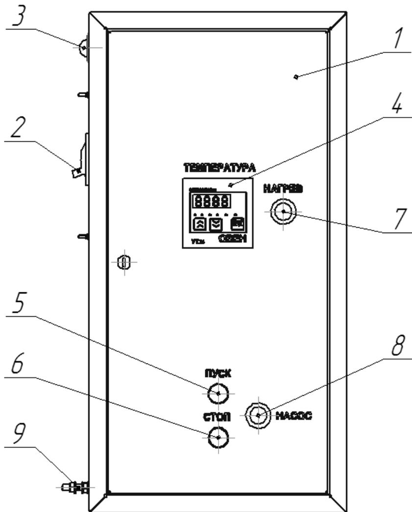
1-дверка шкафа; 2-автоматический выключатель; 3-индикатор включения сети; 4-регулятор температуры; 5-кнопка пуска электронасоса; 6-кнопка остановки электронасоса; 7-индикатор включения электронагревателей; 8-индикатор включения электронасоса; 9-элемент заземления.
