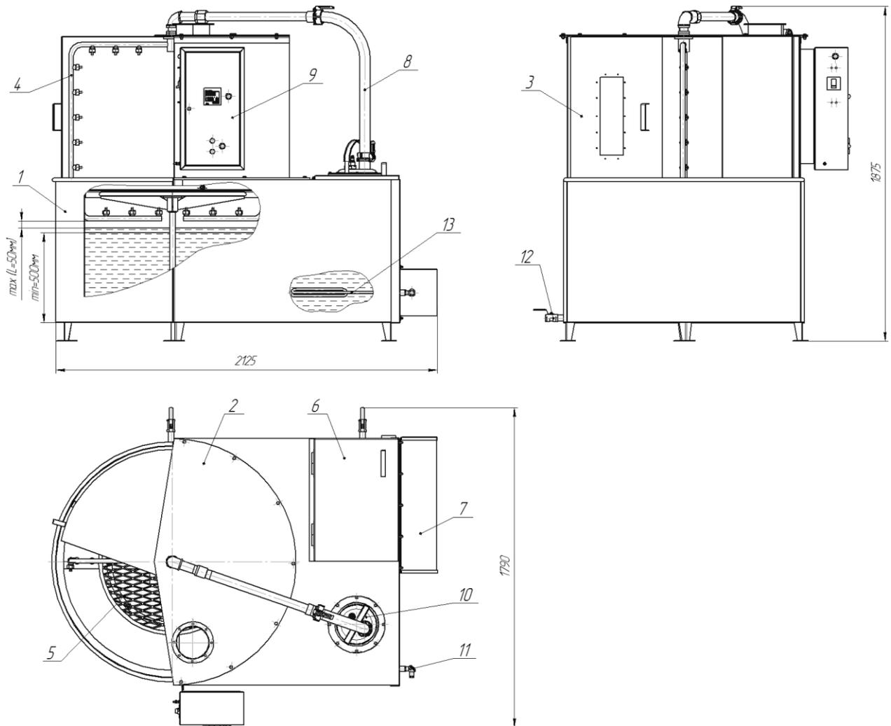
1-ёмкость; 2-мочная камера; 3-кожух; 4-мочный узел; 5-стол поворотный; 6-крышка смотровая; 7-кожух защитный электронагревателей; 8-гибкий трубопровод (рукав) Ду50; 9-шкаф электрический; 10-электронасос; 11-трмопреобразователь сопротивления; 12-кран сливной; 13-электронагреватели.
